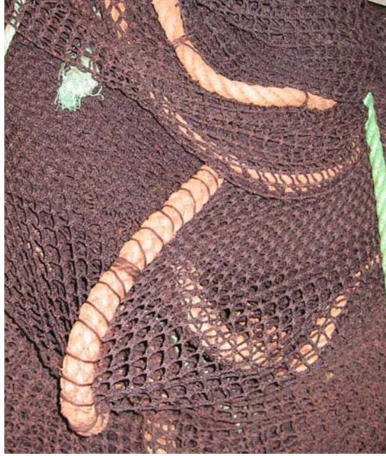
Bilde 6: Tauene krymper etter hvert når nota brukes. De blir tykkere og kortere.
