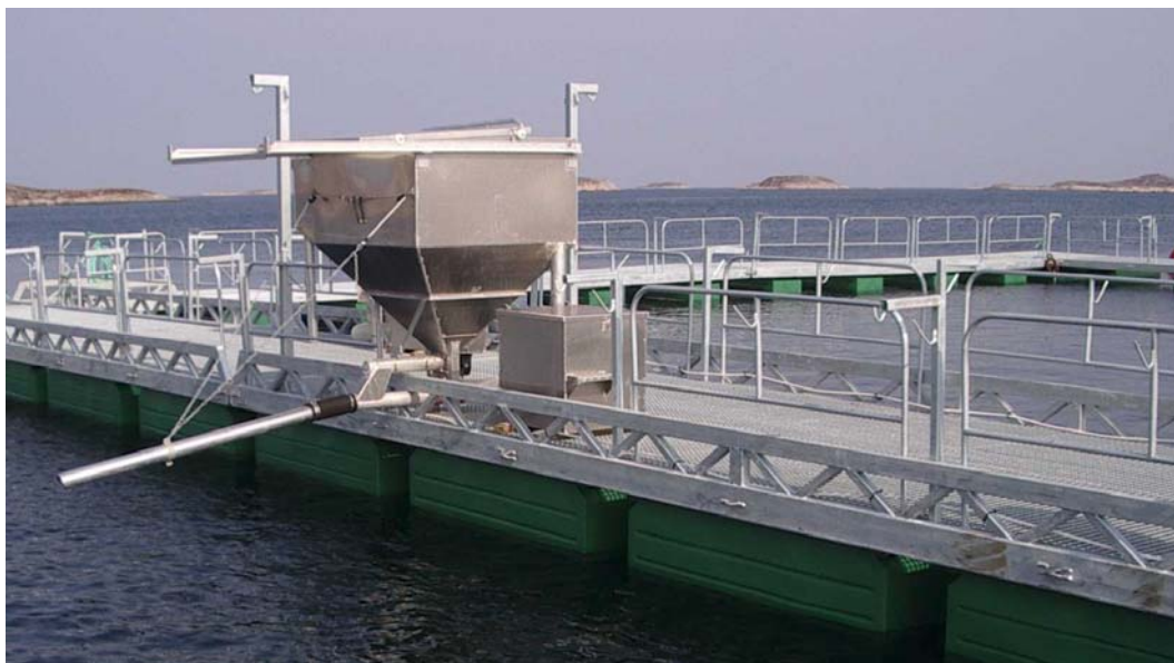
Bilde 4: Fôautomat og fester for notposen.
