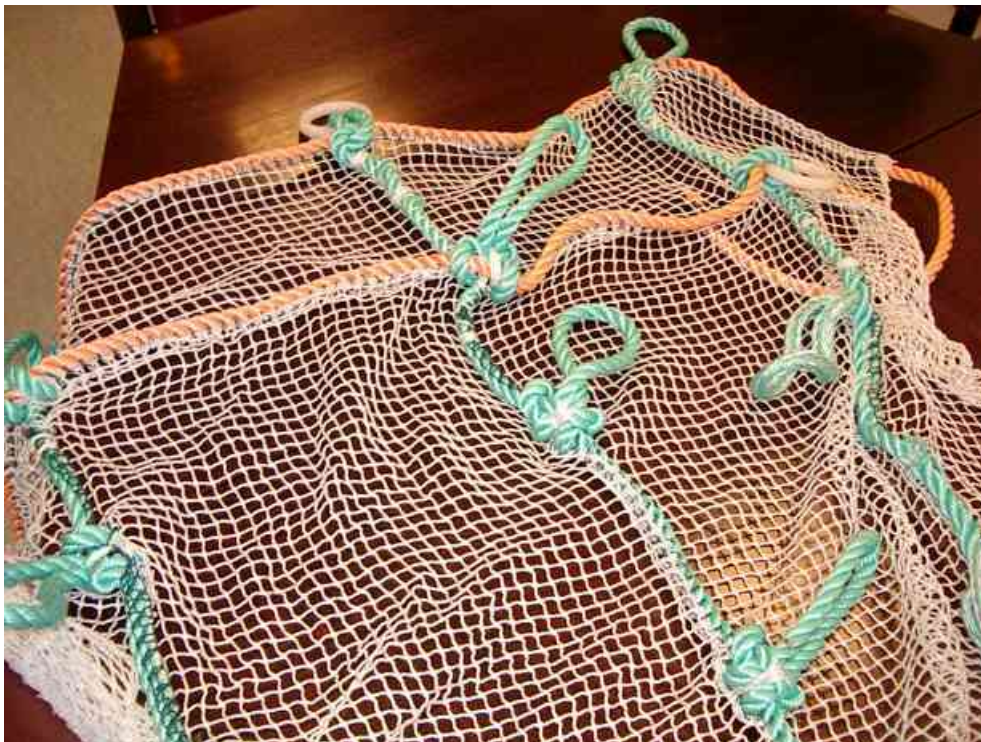
Bilde 1: Modell av notpose (side). Grønne tau er vertikale stavtau. Øverste røde tau er toppen av "hoppnett". Neste røde tau er topptau, med grønne løkker som fester noten til flyteren. Man ser at notlinet blir sydd direkte fast (gjennom) tauverket (reduserer slitasje).
